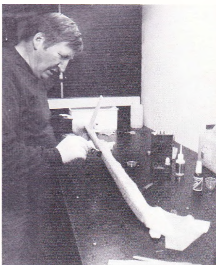
Når polyestern er blandet, er det med at være lidt rap på fingrene, inden den bliver for stiv at arbejde med.
