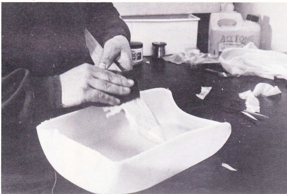
Inden det ekstra lag glasvæv blev lagt på, demonstrerede Poul Erik, hvor hurtigt næsen kunne slibes helt glat med vandslibepapir.
