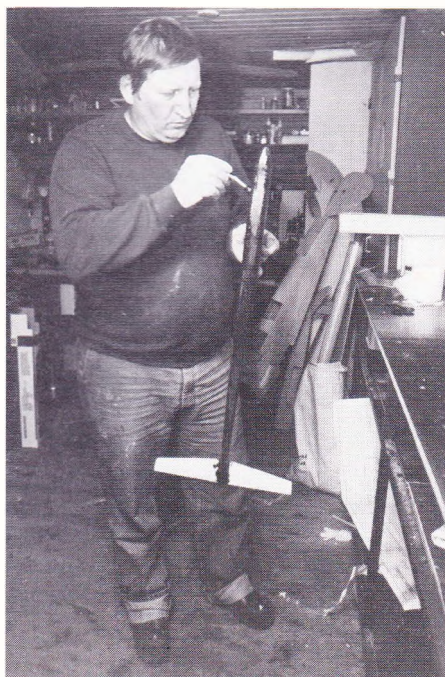
Inden det ekstra stykke glasfiber lægges på, er der blandet polyesterfarve i bindemidlet.
