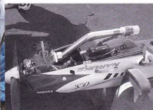
De lette Nomex plader, her med glasvæv. De bruges meget til servoplader. Begge servoer er de nye digitale. Rorhornet er også her lilla eloxeret aluminium.
