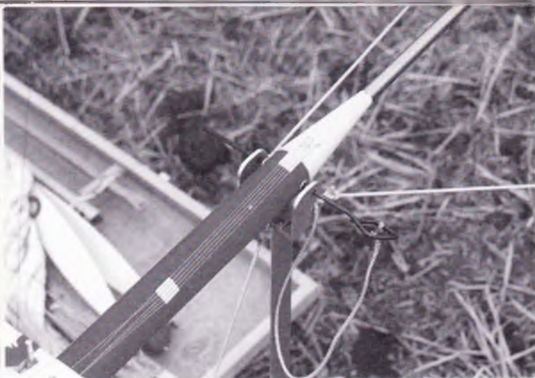
10. Modellen i opræksstativet. Tværpinden er 3 mm pianotråd.
