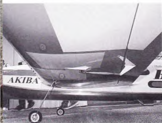
Akibas Beat On med et avanceret træk til krængorrene. Den har lav vægt, men stor styrke.
