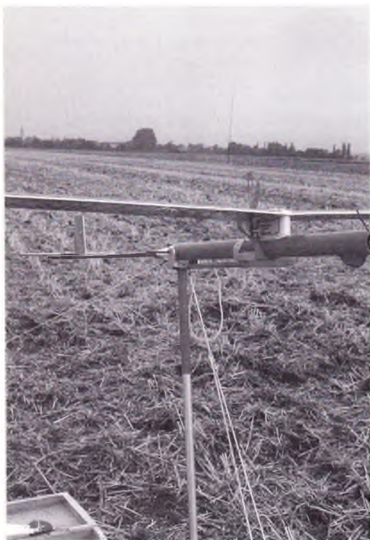
12. Tre solide barduner (den ene kan desværre ikke rigtig ses på dette billede) og meget kraftige teltpælke holder opræksstativet på plads. Der er store kræfter i sving, når man trækker op.
