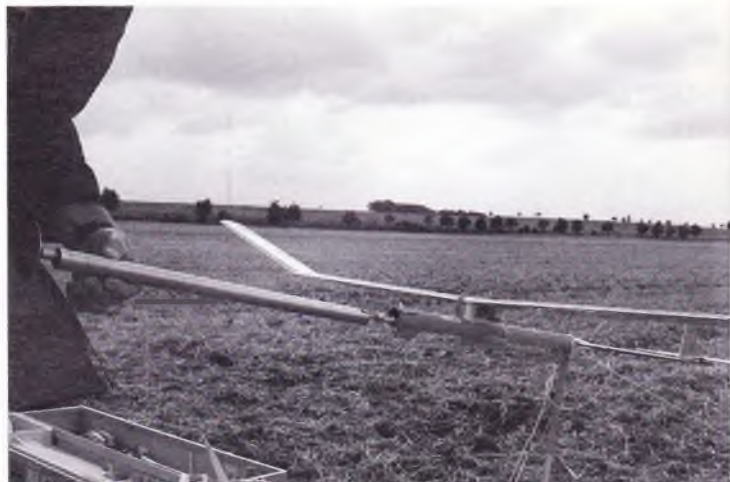
14. Beskyttelsesrøret trækkes ud efter endt opræk.
