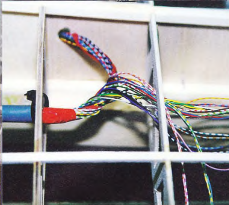
Billederne her giver et indtryk af de omfattende elektriske installationer, der er nødvendige for at få en så stor model i luften. Herover er det et multikabel med 48 ledninger, som fører ud i hver af vingerne. Og til højre ses den "sorte kasse" med al elektronikken og computerstikkene.
