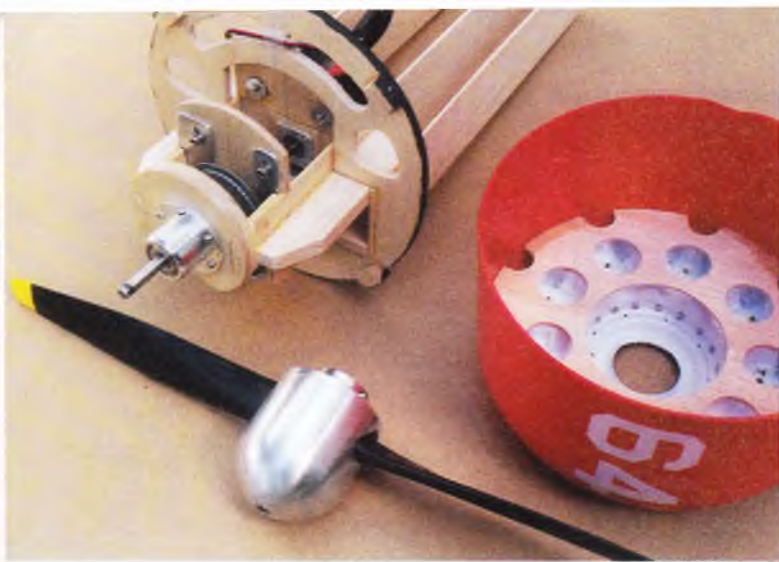
El-motorens indbygning i dummy motoren samt cowlet med krydsfinerspladen med de ni udskæringer til køleluft.
