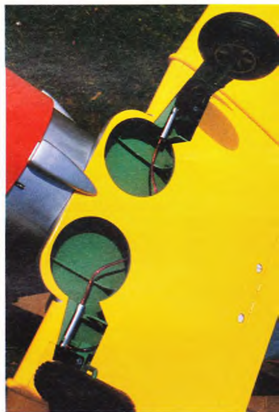
AT-6 giver mulighed for at arbejde med mange spændende detaljer som f.eks. det oprækkelige understel.
