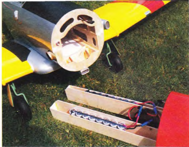
Batterikasserne måtte forlænges en del bagud; men med denne konstruktion blev der forholdsvis nem adgang til dem.
