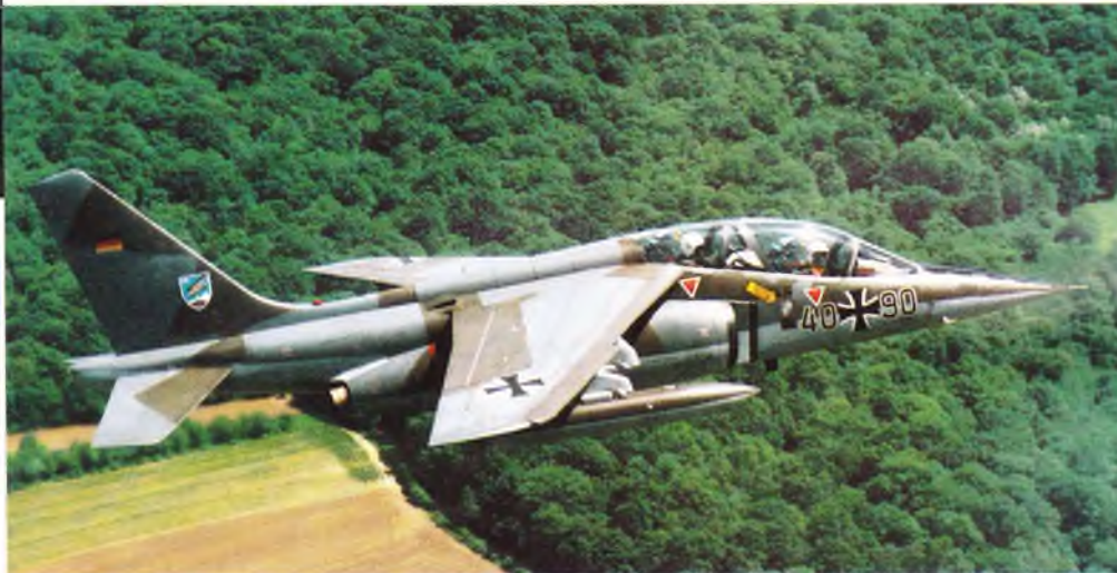
Foruden hos tyske Dornier er AlphaJet også bygget hos franske Dassault. Den mest iøjnefaldende forskel på den franske (øverst) og den tyske udgave er i næsepartiet, hvor den franske er afrundet, mens den tyske er spids.
