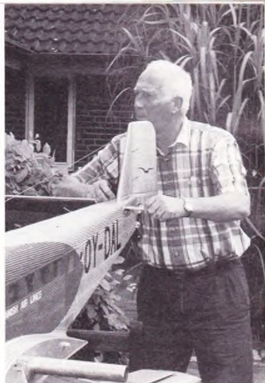
Leo Eriksens seneste projekt er en Junkers JU-52 – populært kaldet Tante Ju – som han her er ved at samle. Bemærk aluminiumsrøret, som er til monteringen af vingerne.
