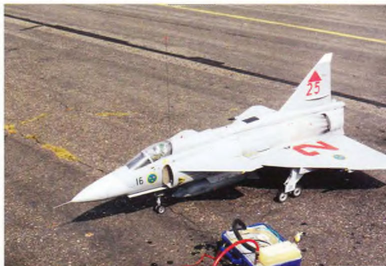
Lasse Palms "brutale Viggen". Modellen er udstyret med en Turbomin turbine, som er en uddæende race inden for jetmotorer.
