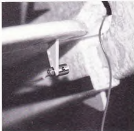
Med de medfølgende rorfittings er det nemt at justere rorfladerne.
