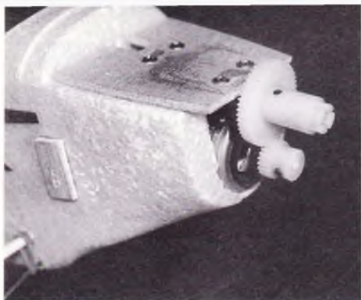
Motorfundamentet limes på plads, her med den gearede motor skruet fast. Uden gear limes motoren fast i selve fundamentet.
