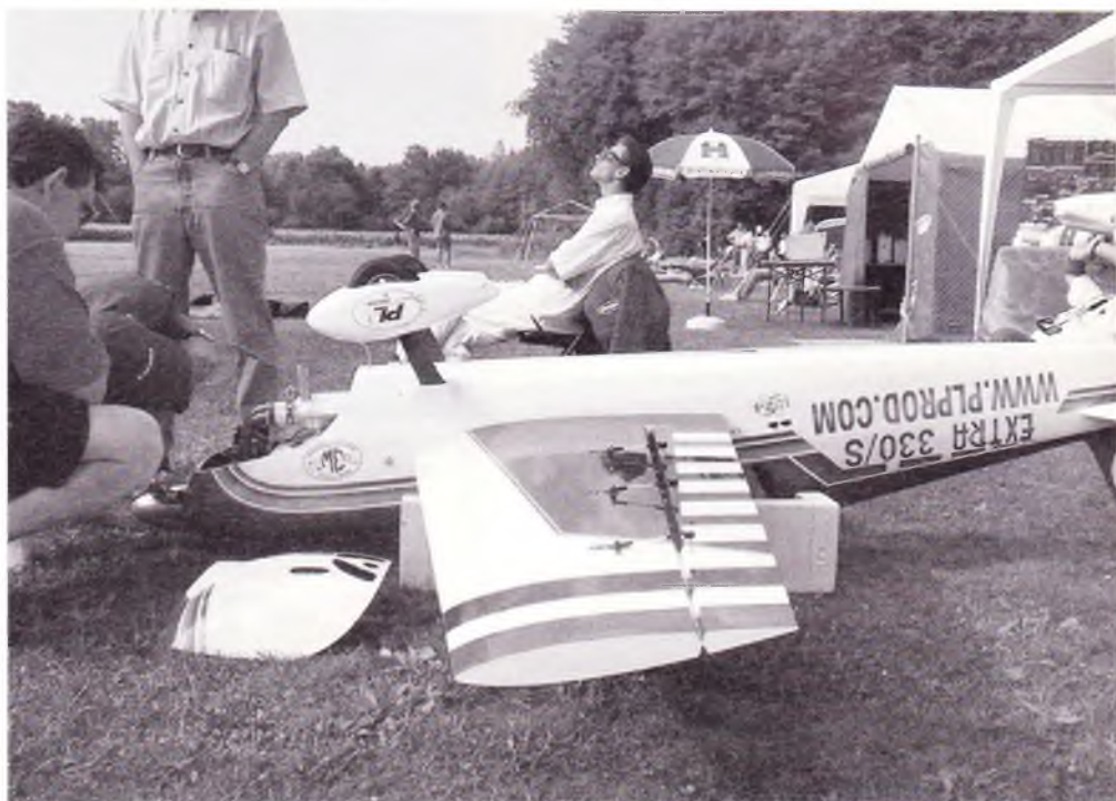
15 kg modellfly med en spændvidde på ca. 320 cm og med 6 servoer til krængeror, 4 til sideror, 4 til højderor og så kun én til gassen.
