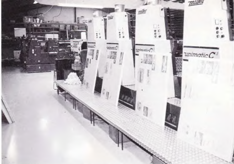
Fire offsetplader klar til at blive monteret i trykmaskinen. Den opmærksomme læser vil have bemærket, at pladerne er næsten ens (forskellen kan være forskellige raster). Det skyldes, at det er farvesider, som trykkes ad fire gange. Rækkefølgen er sort, cyan (blå), magenta (rød) og gul.
