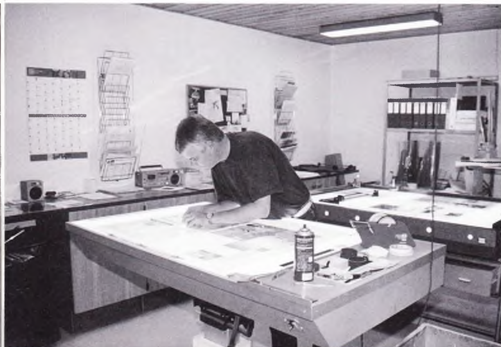
Torben ved montagebordet, hvor filmene monteres, inden de kopieres over på offsetplader.
