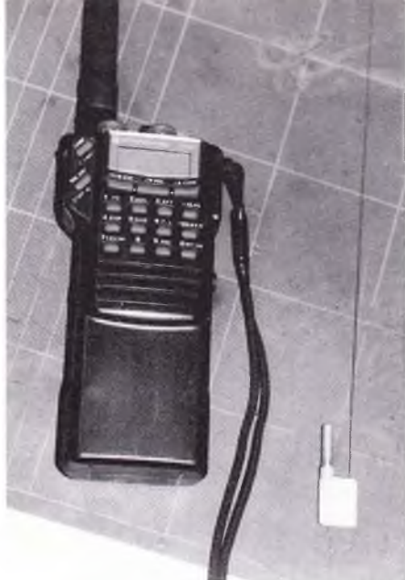
Den lille sender – ca. 3 gram – med batteri og antenne klar til montering i modellen samt walkien til sporingen (og lokal snak!)
