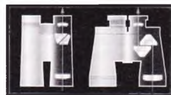
Fig. 1 Kikkerten til venstre har tagprismer og den til højre porroprismer.
