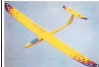
Parabola spv. 190 cm til elektro eller 2400.- skrænt. 100% GFK model med kulfiberhovedbjælke og kevlarforstærket krop. Vingen er i et stykke og modellen er velegnet som introduktion til 10 celled klassen
