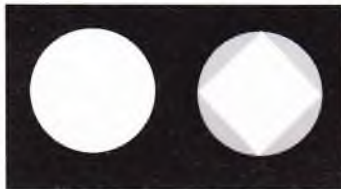
Fig. 2 Til venstre ses okularet (tættest ved øjet) fra en god kikkert. Skyggerne på det andet er tegn på en dårlig optik.
