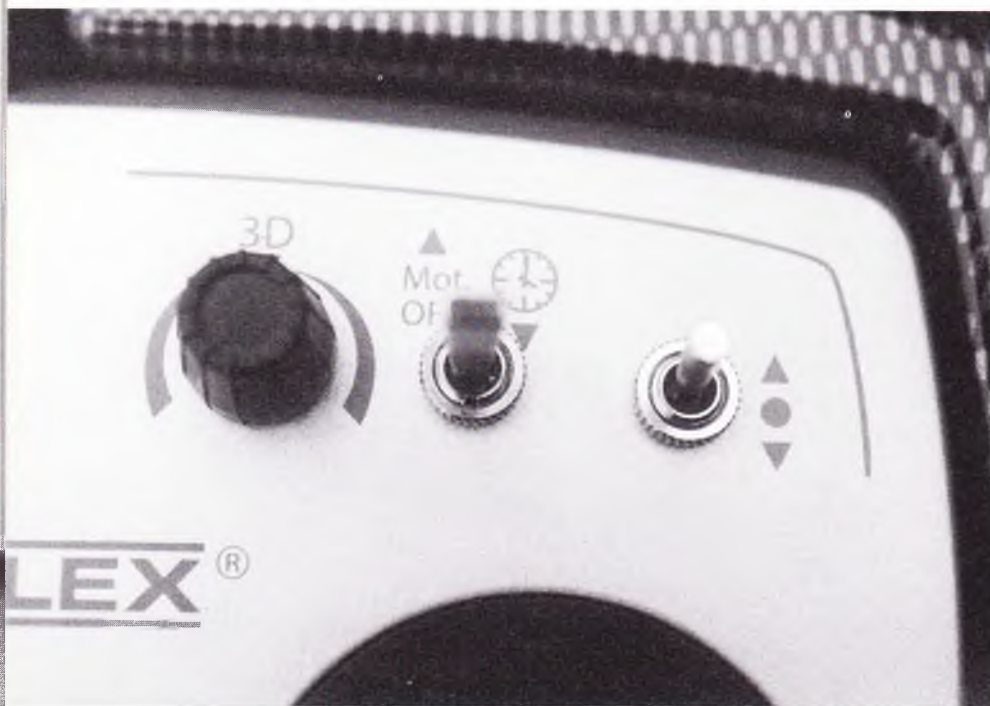
Til venstre 3D-knappen til at betjene menuerne med. "3D" fordi man kan både dreje på den og trykke på den. I midten switch til start/stop af motortid (frem) og motorstop (tilbage). Til højre en kanalswitch.
