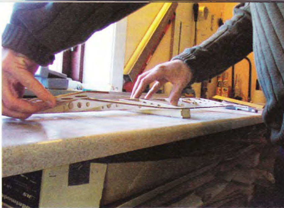
Man kan se, hvor meget vingen kan vride uden de ekstramonterede stivere.
