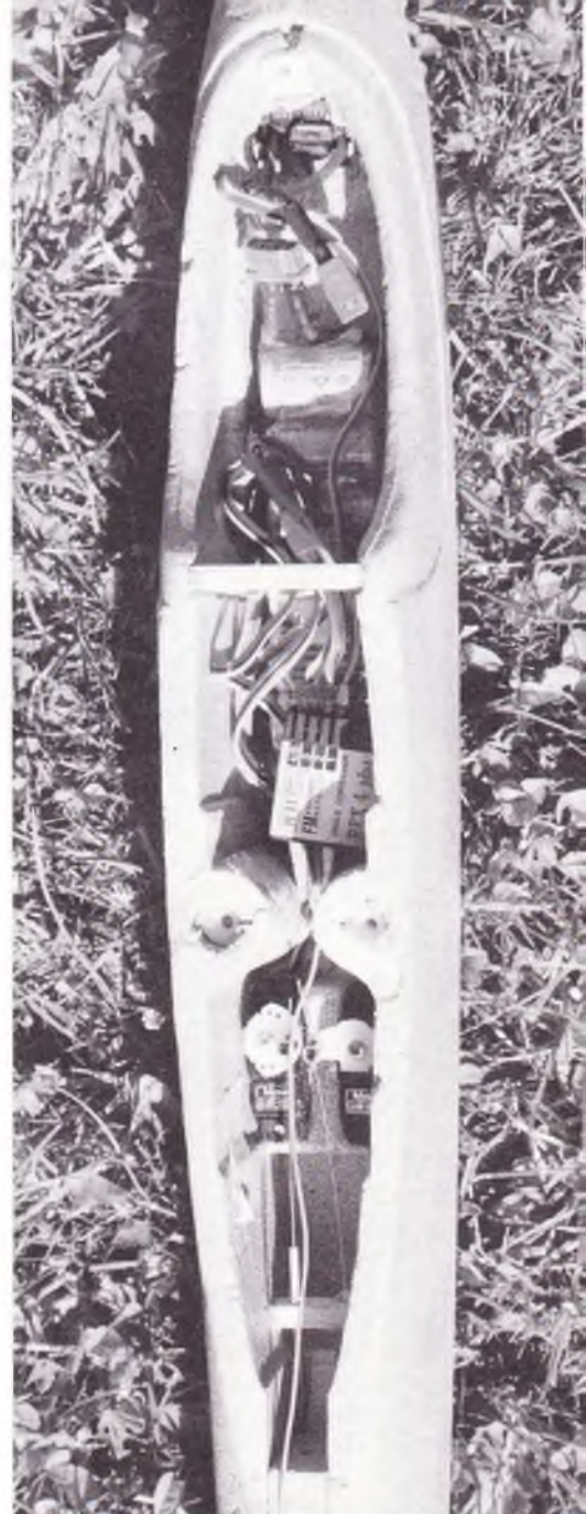
Der er "masser af plads" i kroppen til det nødvendige radiogrej og batterier.
