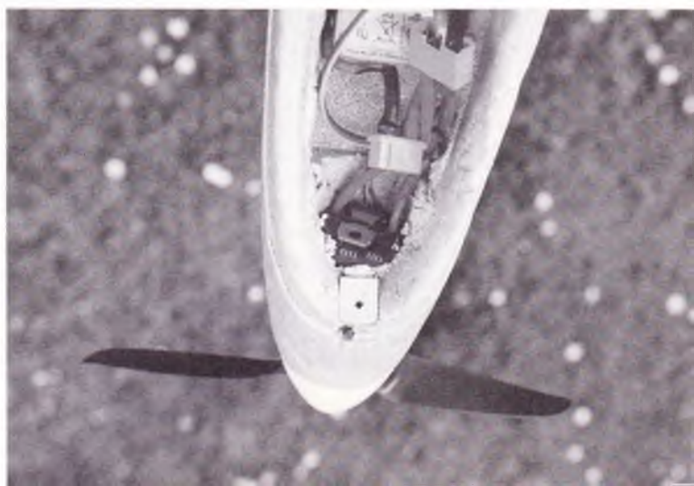
Hvis man bruger motor med monteret regulator, spares der lidt plads.
