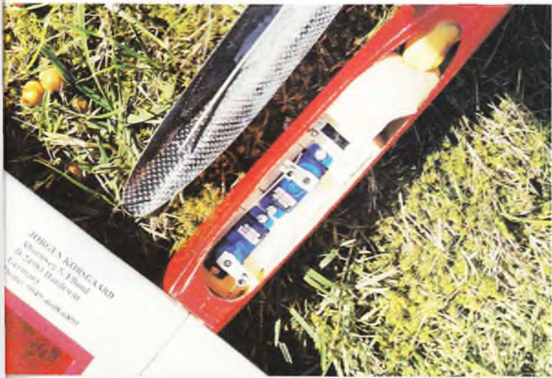
Et kig ind i "cockpitet" med mikroservoer. Canopiet er kulfiber.
