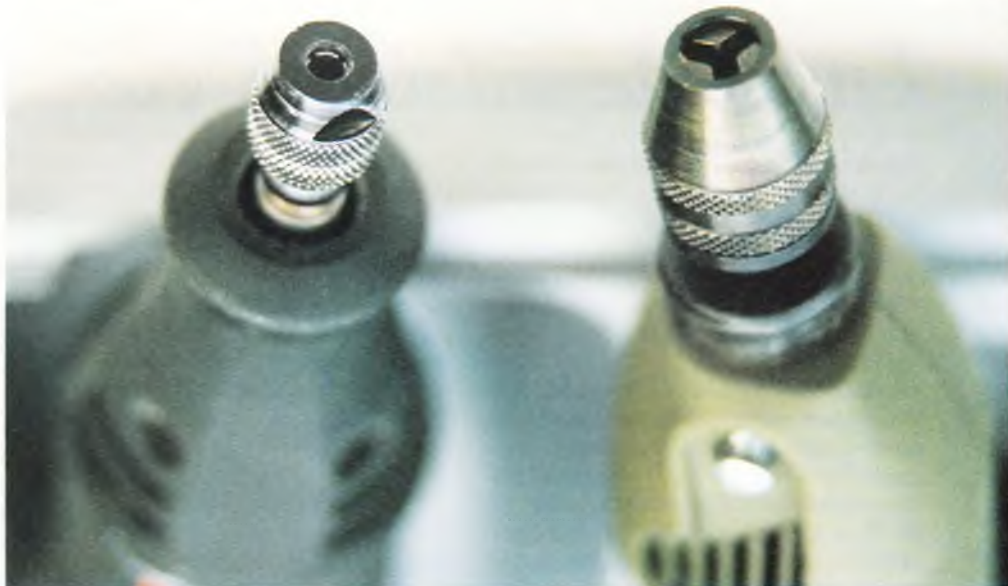
Dremel Multi (t.v.) og TopCraft har borepatronindsatser med to størrelser, mens Proxxon FBS (t.h.) har en mere praktisk borepatron med tre kæber.
