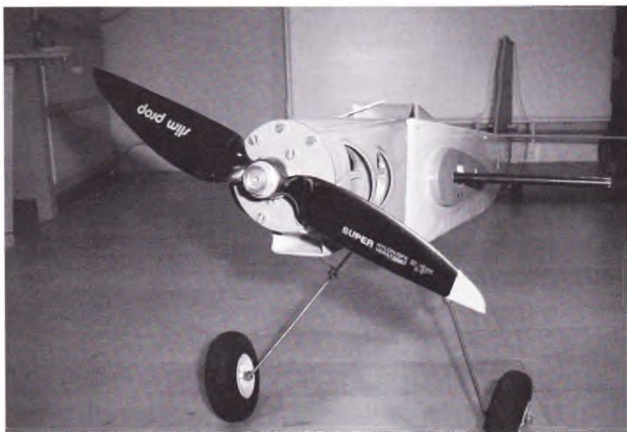
Billede nr. 4. Bemærk de mange luftindtag. Luften kommer ud efter at have passeret akkumulatoren over kroppen.
