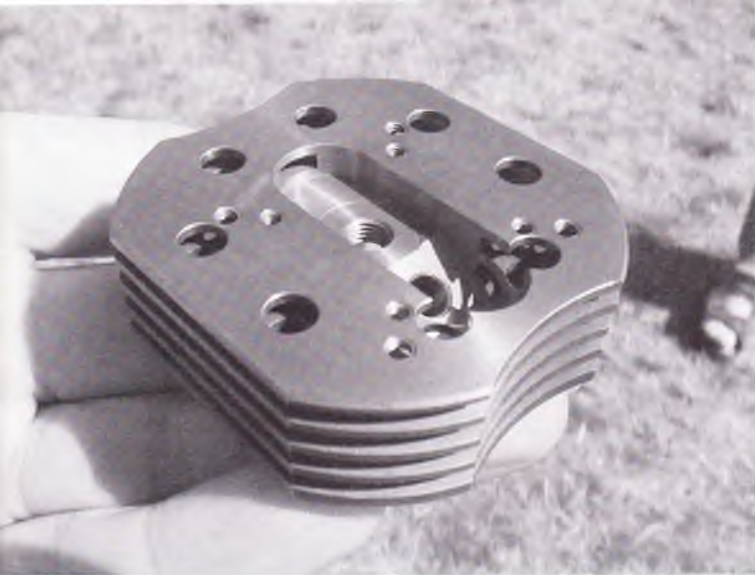
Specielt topstykke til OS 140. To gløderør giver en bedre mellemgas og mere ydelse.
