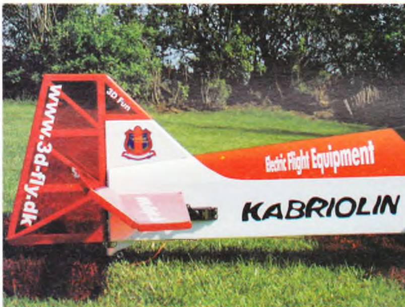
Højderorsudslag. Bemærk servoren er placeret lige foran haleplanet. Fotograf: Flemming S. Nielsen
