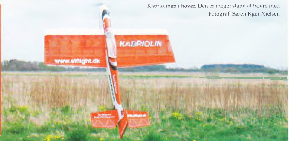
Bemærk størelsen af højderoret i forhold til resten af haleplanet. Fotograf: Flemming S. Nielsen
