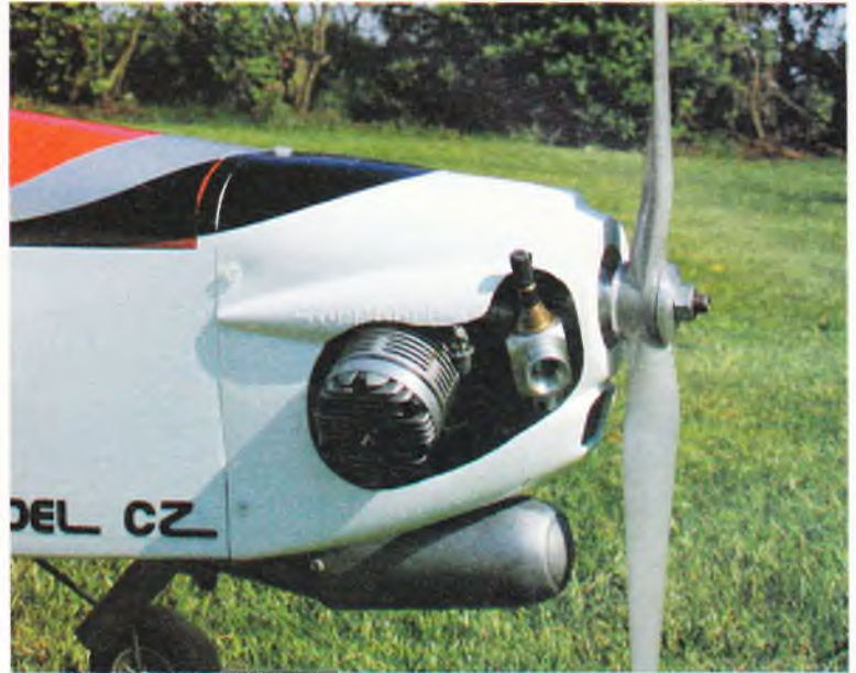
Motorinstallation. Der er valgt en installation hvor Webra'en hænger stramt ned ad. Fotograf: Flemming S. Nielsen
