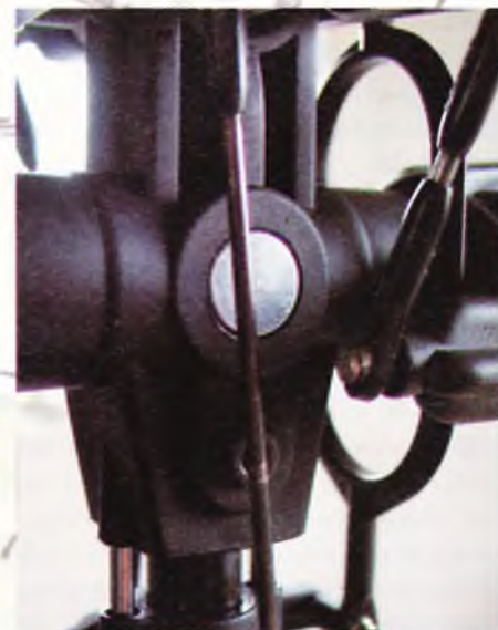
Hullet til hovedrotorakslen i centralstykket var i version 1 ofte boret skævt.
