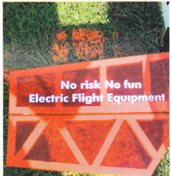
Bemærk størelsen af højderoret i forhold til resten af haleplanet. Fotograf: Flemming S. Nielsen
