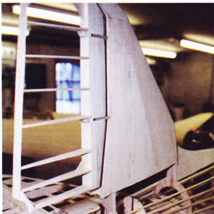
Halepartiet hvor man måske kan ane, hvordan flyet går ned i et "T". Foto: Arild Larsen
