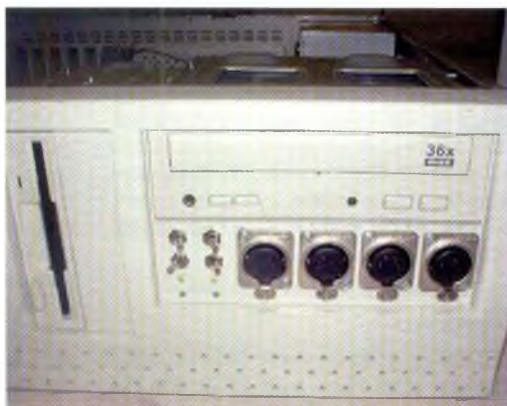
Anslutningspanel för stegmotorerna. X Y Z och framtida A. Brytare för hel / halvsteg.
