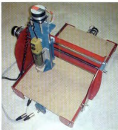
Den färdiga fräsen från ovan med en Proxxon fräs monterad. Fräsytermått ca 600X400 mm. Fräsbar yta 295 X 410 mm.
