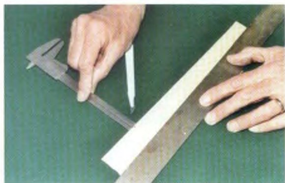
Håll fast skjutmättet och för upp linjalen mot spetsen av ditt skjutmåts så kallade djupmått.
