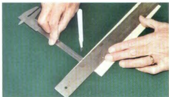
Listskärning: Du behöver skjutmått, metallinjal, skalpell. Ställ skjutmättet på den listbredd du önskar plus halva knivbladets tjocklek samt vänd skjutmättet med skalan mot kanten av flaket.
