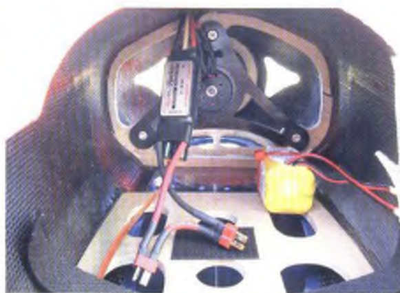
Insidan av Jason Shulmans eldrivna Rhapsody. Notera att motorn även är uppfäst i bakkant för att inte bryta sönder hela kroppen.
