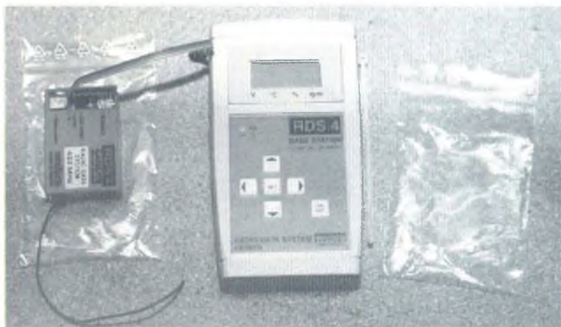
RDS-sändaren är den lilla röda asken som ser ut som en mottagare. RDS mottagaren, den stora boxen, kan man i realtid följa volt, temperatur, ett servoutslag i % och varvtal.
