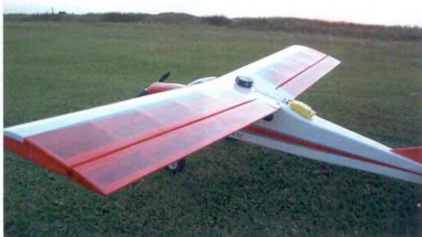
Nästa projekt - installation i en något större parkflygare Wattage Super Impress med GPS (gul) och Co-pilot (IR-enhet) synlig.
