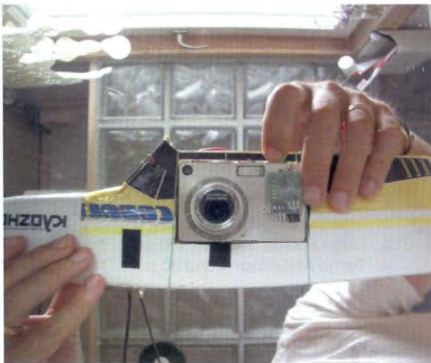
Installation av Pentax Optio S4 i en tidigare Kyosho Ferias
