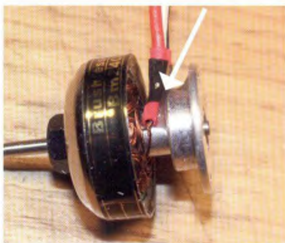
Bell-motorn heter "Tower Pro" hos Smartec (i Frankrike och Tyskland heter den Blackstar 10). Pilen pekar på fixeringen med epoxy som vi gjort för att tilliedningskablar ska sitta fast mot bakstycket.
