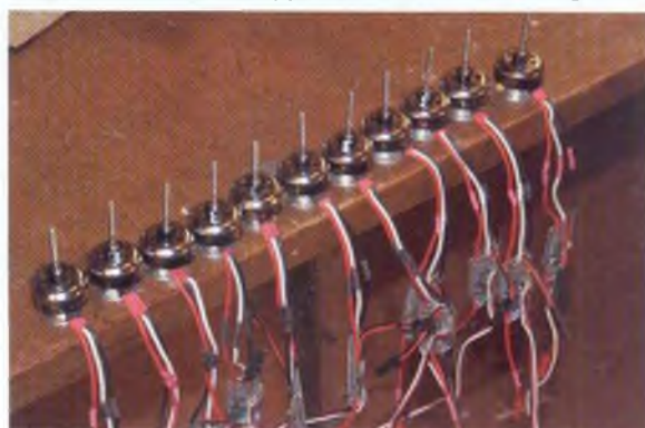
Det tog oss en arbetskväll att löda samman fartreglage och motor och att epoxifyrsträcka trefaskablarna.
