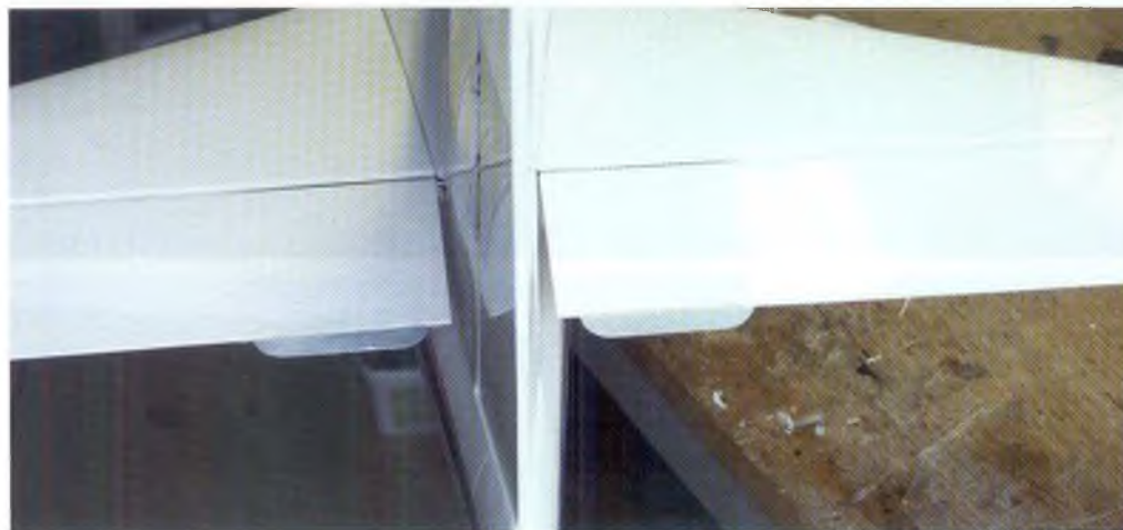
Det här är motmedlet mot roderfladder. Trimplåtarna är inskjutna ungefär 6 mm i bakkanten på rodren och vinklade nedåt ungefär 5°
