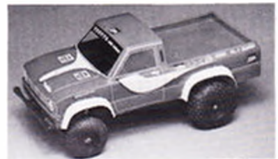
Robbe Toyota Hilux. Længde 410 mm. Kobling, gearkasse, fartregulator. Motor 7,2 V.
