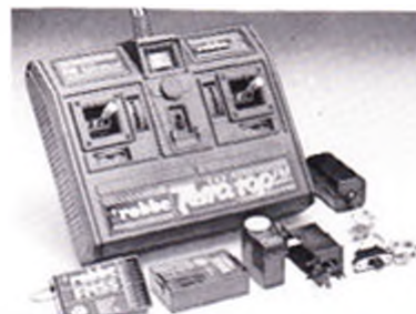
Robbe Terra Top 4-kanals anlæg, der kan udbygges til 8 kanaler.
