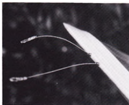
Udføringsrørene føres gennem balsaen i tippet.
