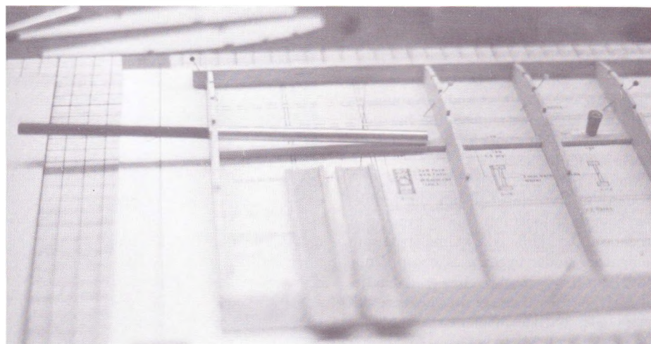
Her er vist aluminiumsbærerøret, kulfiberstangen og de to forstærkninger af 2 mm krydsfiner, som skal sidde mellem ribbe 1 og ribbe 4.
