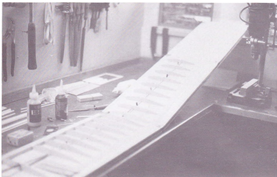
Ved hjælp af to Graupner byggebrædter er her vist opstillingen til højre vingehalvdel. Man kan ved hjælp af denne metode bygge vingen i ét stykke.
