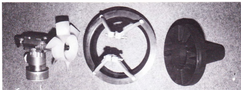
De vigtigste dele til et fan-fly.
