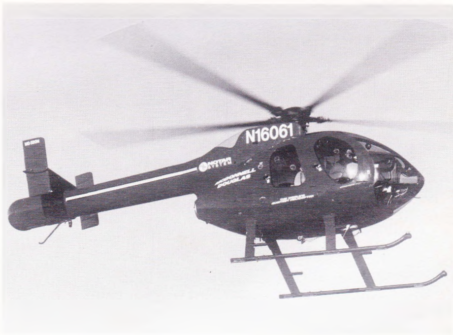
NOTAR hedder de nyeste helikoptere fra McDonnell Douglas til efternavn. Det står for No Tail Rotor – ingen Halerotor – og denne revolutionerende konstruktion er blevet betegnet som det største fremskridt inden for helikopterteknologien, siden denne type luftfartøjer blev til.
