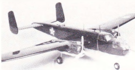
Dobbelte sideror som på denne B-25 Mitchell giver en god styring på sideroret.
