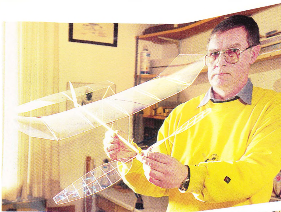
Jørgen Korsgaard med F1D mikrofilmmodellen, som uden elastikmotor vejer ca. 1 gram.
