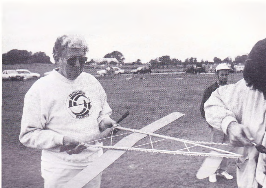
Erik Knudsen assisterer ved cotrækket af en »twin pusher« model. Typen er fra omkring 1910 og forsynet med to modsatrettede, skubbende propeller. Den flyver med »halen« forrest og er altså en såkaldt andemodel.
