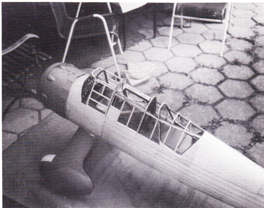
Her ses kroppen efter beklædningen af Coverite. Man kan se instrumentbrættet. Desuden giver billedet et godt indtryk af, hvordan cockpittet er opbygget. Det er et større arbejde at få lavet alle »vinduerne« og sat dem på plads i rammerne.
