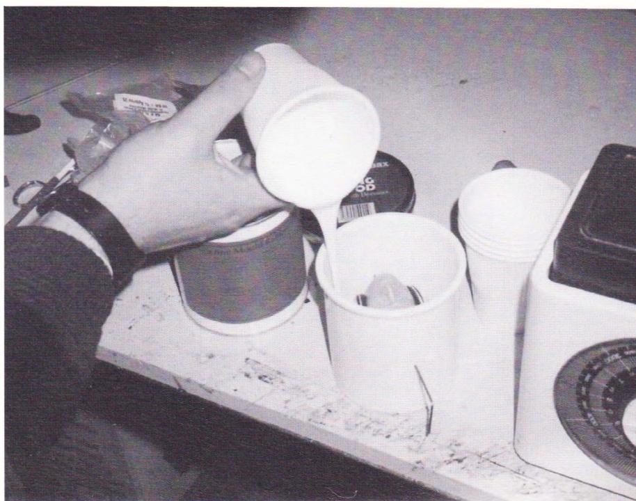
Med pilothovedet fremstillet i modellervoks som udgangspunkt fremstilles stobeformen af siliconegummi i en plastickop.
