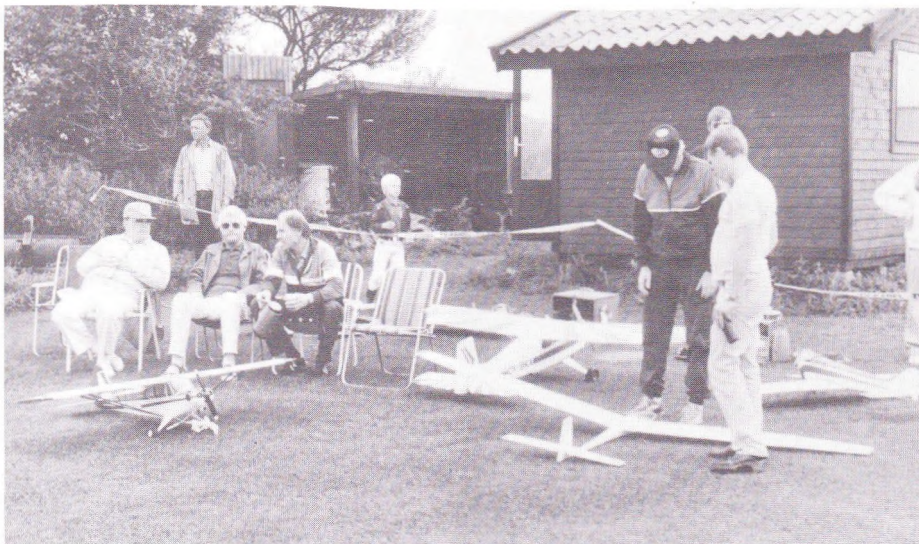
Herover Ole Hilmer Petersen's »Druine Turbulent« med Enya 46 4C motor. Den styres på 4 kanaler og vejer 2.800 g. Spændvidden er 150 cm.
