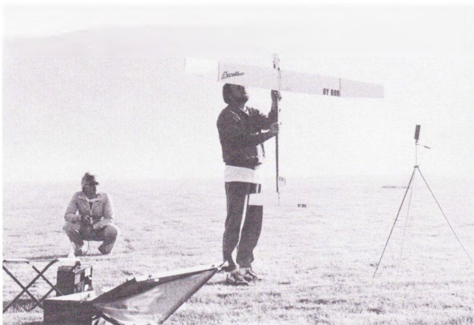
Thomas Køster med sin nye »plastic-model« Excalibur. Hele modellen er støbt i roha-cell, glasfiber, kulfiber og epoxy. Den flyver formidabelt, men mod for tidlig termikbremse har den ingen chance. I baggrunden vogter Dave Rounsaville over Thomas og modellen.
