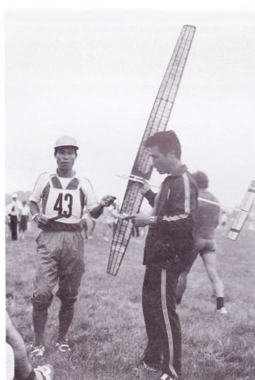
En nordkoreansk FIA-flyver fra Riesa International i Østtyskland. Bemærk den åbne vingestruktur med de mange krydsribber. Foto: Per Grunnet.
