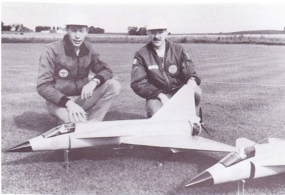
KFK's formand Erik Huber og Flemming Madsen med deres Saab »Viggen« modeller bygget efter Topp Modelle byggesæt. Motor Webra Speed 10 cm 3 , vægt ca. 4,5 kg og spændvidde 120 cm.
