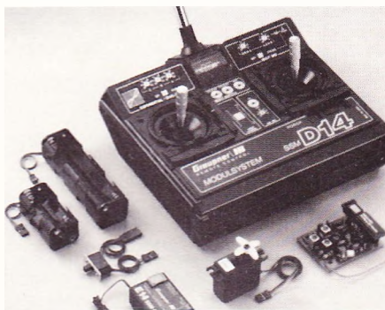
Graupner D-14. 4-kanals anlæg incl. 4 servoer af typen C-505 ..... kr. 1.815,-
