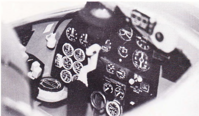
Instrumentpanelet med flyve- og motorinstrumenterne og med håndtag til understel og flaps. Bemærk kompasset og lampen i siden.
