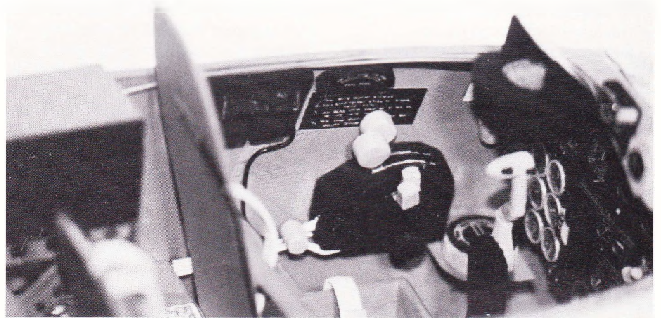
Instrumentpanelet med flyve- og motorinstrumenterne og med håndtag til understel og flaps. Bemærk kompasset og lampen i siden.
