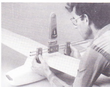
Indfaldsvinkelmåler til kontrol af indstillingsvinklen på hoved- og haleplan.
