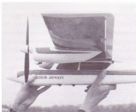
Billedet giver indtryk af den gennemtænkte motormontering i to naceller. Foto: B. Tangø.
