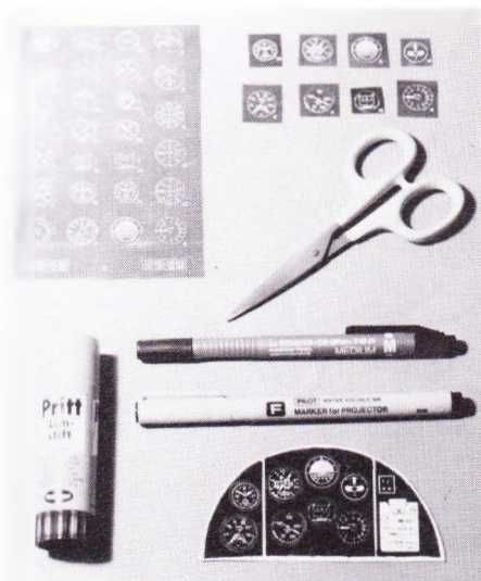
Kopi af instrumenter, løse instrumenter samt det nødvendige værktøj til at fremstille det færdige instrumentpanel nederst til højre.
