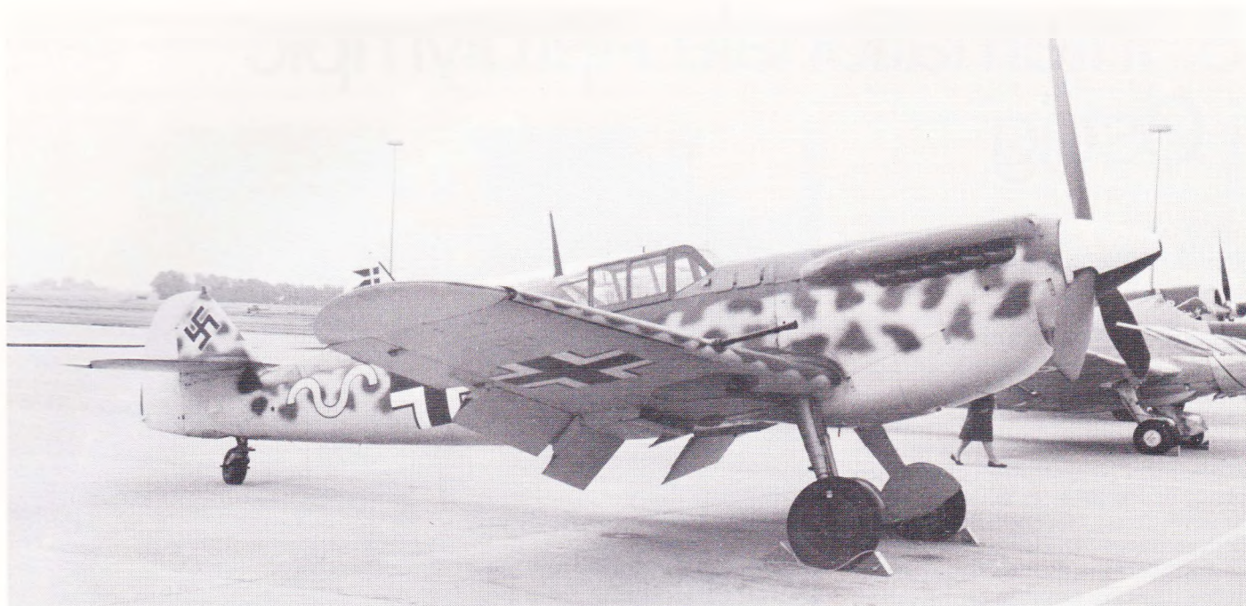
Den lidt usædvanlige næse på Messerschmitt'en afslører, at flyet er udstyret med en Merlin motor i stedet for den originale Daimler-Benz.
