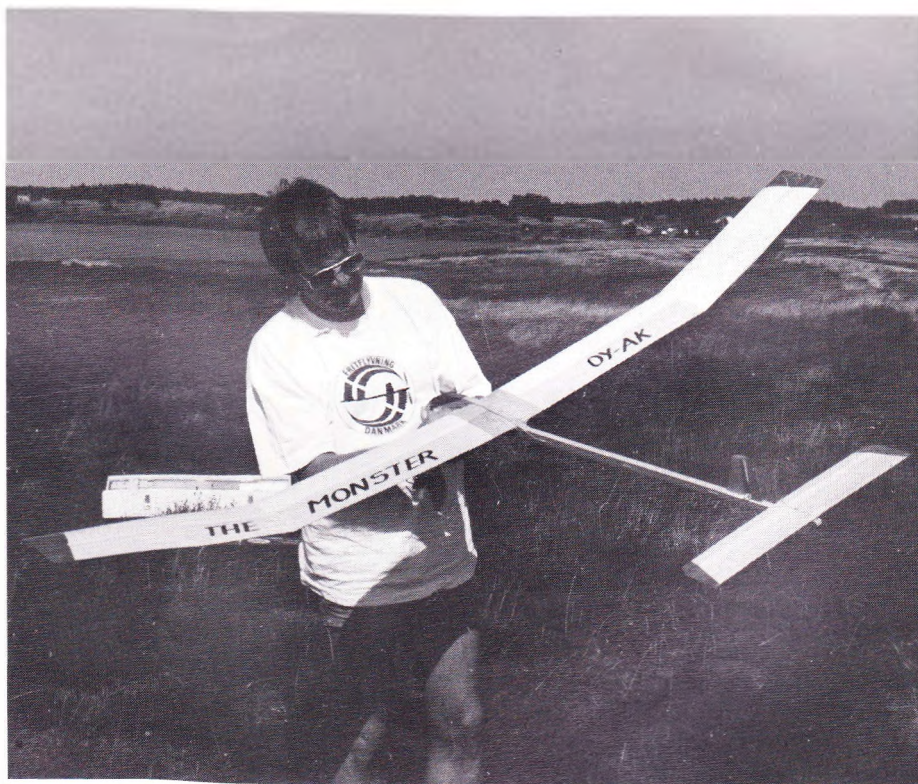
Der kan anes, at der er STEPPED TURBULATOR på vingens overside. Den har dog også turbulens-tråd på forkanten.
