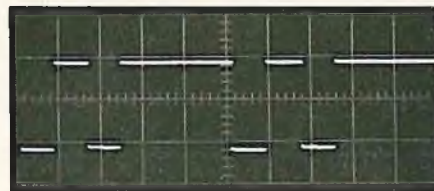
A: 2 volts/cm vert. 1 mill sec/cm horiz.
