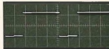
C: 2 volts/cm vert. 1 mill sec/cm horiz.
