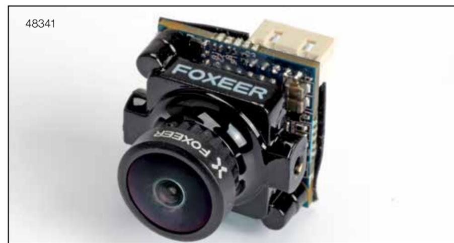
**FPV micro PRO Kamera PAL 160° IR blocked mit OSD**
