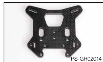
Dämpferbrücke hint. Carbon 5 mm
