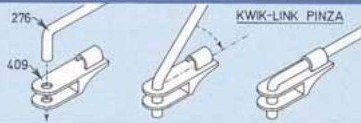
MONTAJE HORN NYLON
