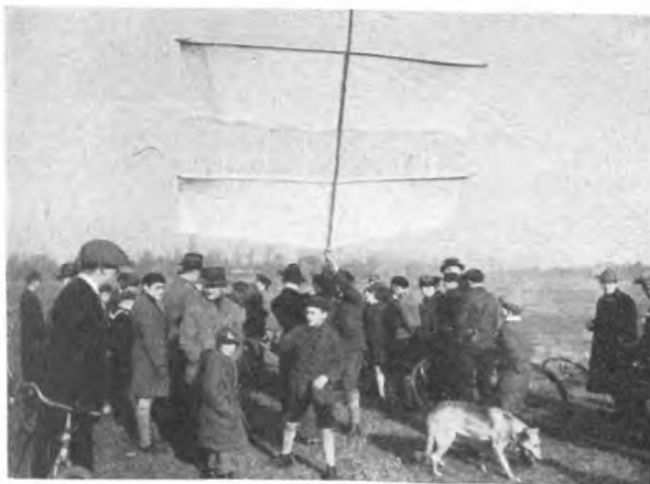
Abb. 5. Drachen zum Start von Flugmodellen mit über 5 qm Flächeninhalt aus dem Jahre 1930.
