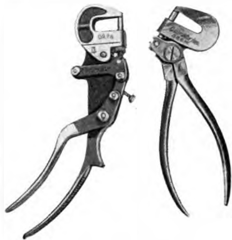
Abb. 7. Die Nietzangen „Constructor“ und „Constructor-Junior“.
