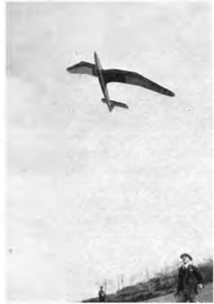
Abb. 5. Überzogene Fluglage eines schwanzlastigen Segelflugmodells.
