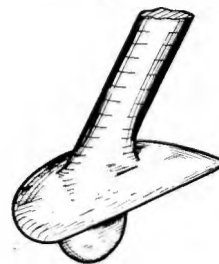
Abb. 4. Das fertige Fahrwerkbein.
