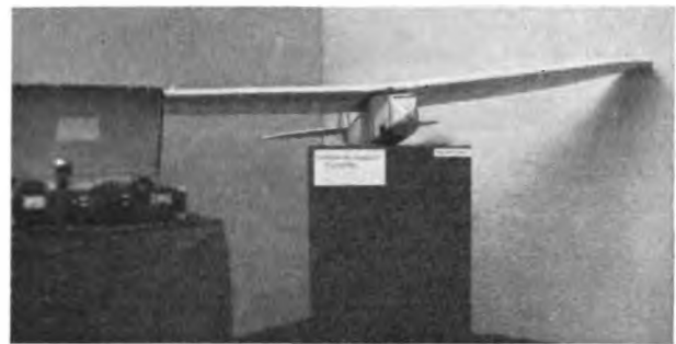
Abb. 1. Das ferngesteuerte Segelflugmodell mit seinem Sender (links).
