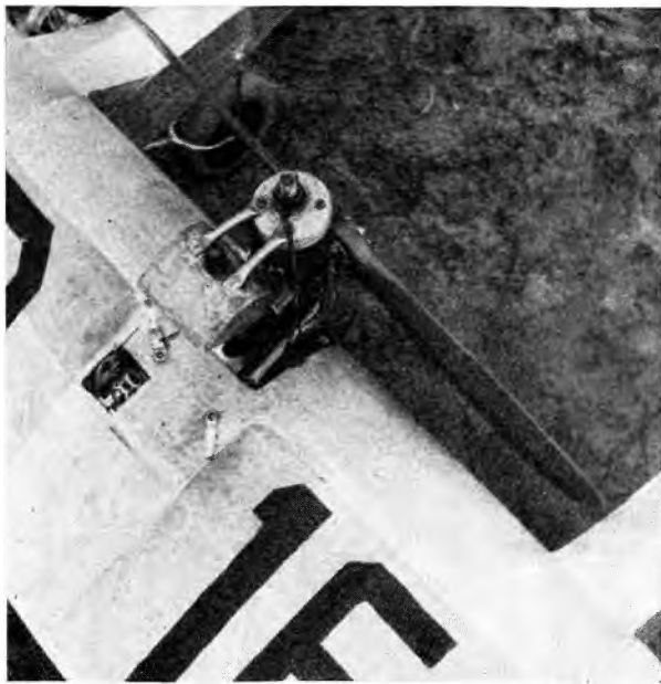
Abb. 10. Triebwerk beim Flugmodell von Aldinger Stuttgart-Cannstatt, mit Uhrwerk/Drosselung.
