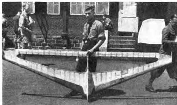
Abb. 3. Schwanzloses Flugmodell aus dem Jahre 1933, das als Weiterentwicklung der schwanzlosen Flugmodelle von Antes anzusprechen ist.
