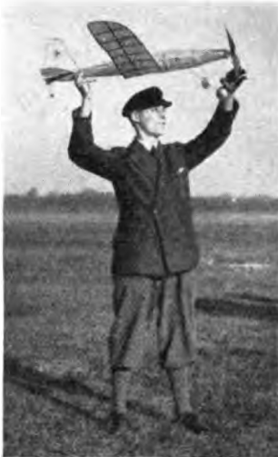
Abb. 7. Leistungsfähiges Kumpfstief- deckermodell mit Flachrippen aus dem Jahre 1930.
