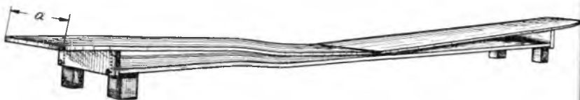
Abb. 3. Vorschlag für eine Tragflügelbauunterlage.
