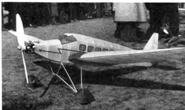
Tschechisches Flugmodell der Ju/52 mit Preßluftmotorantrieb.
