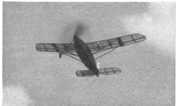
Abb. 2. Rumpfhochdeckerflugmodell vor 1926 mit einseitig bespanntem Tragflügel.
