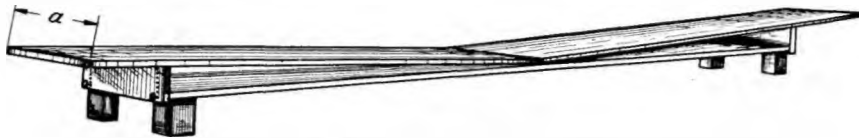
Abb. 3. Vorschlag für eine verstellbare Tragflügel-Bauunterlage.
