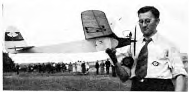
Abb. 8. Das Benzinmotorflugmodell von Krause, Dessau, wies einen akustischen Landeortanzeiger auf.
