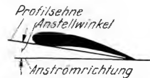
Abb. 33. Der Anstellwinkel ergibt sich aus der Anströmrichtung.
