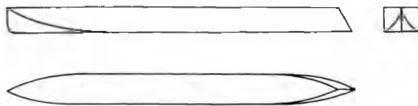
Abb. 12. Stufenloser Schwimmer mit flacher Unterseite aber vorderem Kiel.
