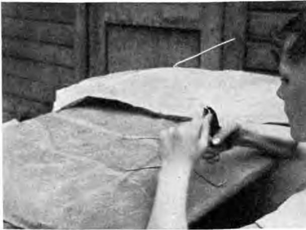
Abb. 8. Bevor der erste Start erfolgen kann, muß der aus einem Drahtgestell und einem Wattedausch bestehende Brenner hergestellt werden. Eine Sonderzeichnung des Bauplanes gibt die Maße an.
