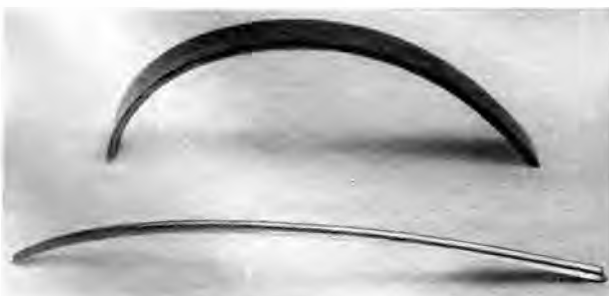
Abb. 2. Biegeschablone für Profilbänder und fertiges Profilband.
