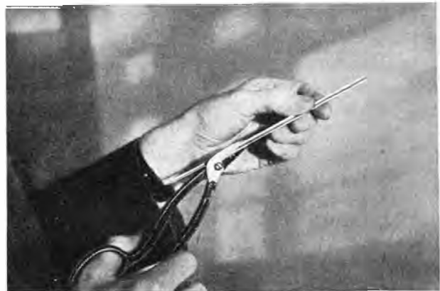
Abb. 5. Richtiges Beschneiden mit der Meco-Blechscherz.
