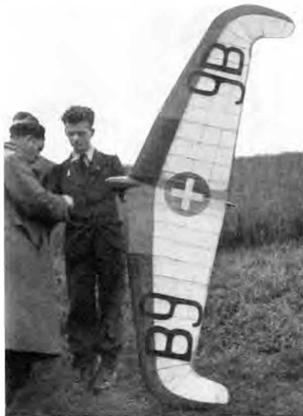
Abb. 1. Schwanzloses Schweizer Segelflugmodell mit eigenartiger Grundrissform. Das Modell hatte gute Längs- u. Querstabilität.
