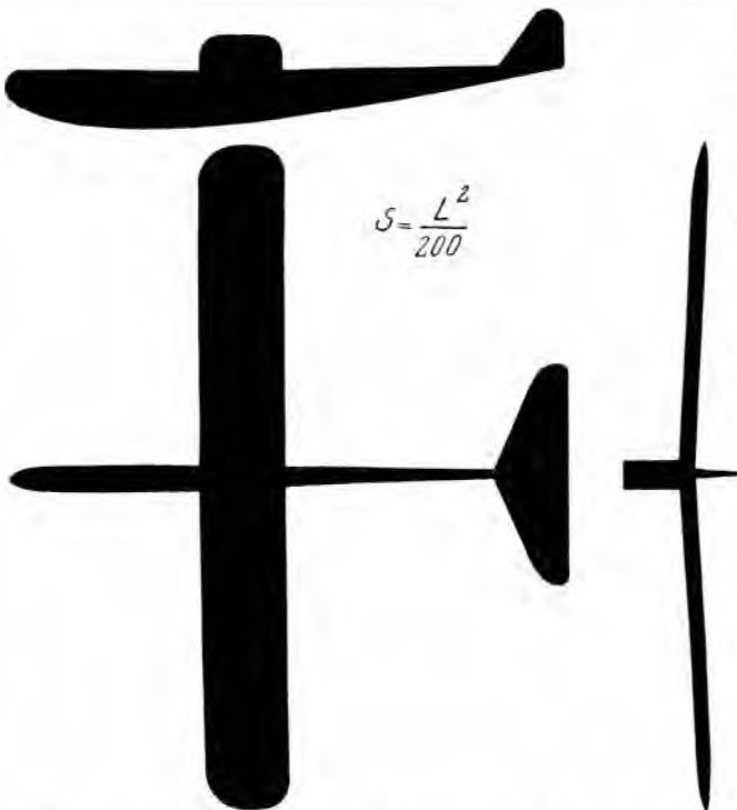
Abb. 1. Schattenriß eines Segelflugmodells, dessen Rumpf der FAI-Formel entspricht.
