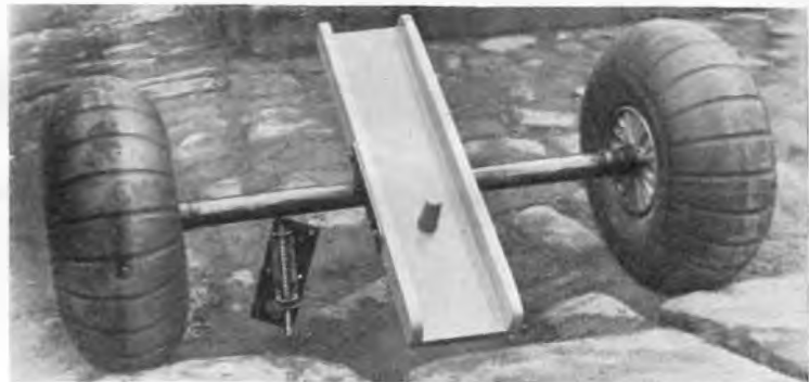
Abb. 12. Abwerfbares Fahrgestell eines Segelflugzeuges.
