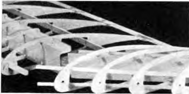
Abb. 3. Probeweise eingefetzter Füllklotz.
