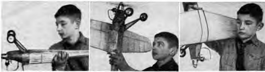
Abb. 3. Der Motor läuft in jeder Fluglage.
