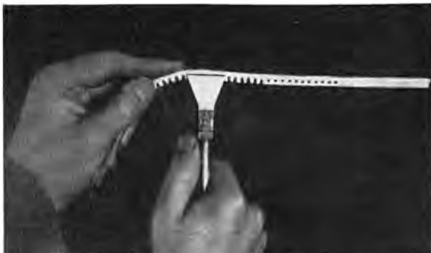
Abb. 7. Biegen des ausgeparten Profils 7.
