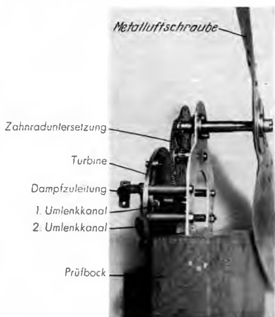
Abb. 1. Aufbau der Dampfturbine.
