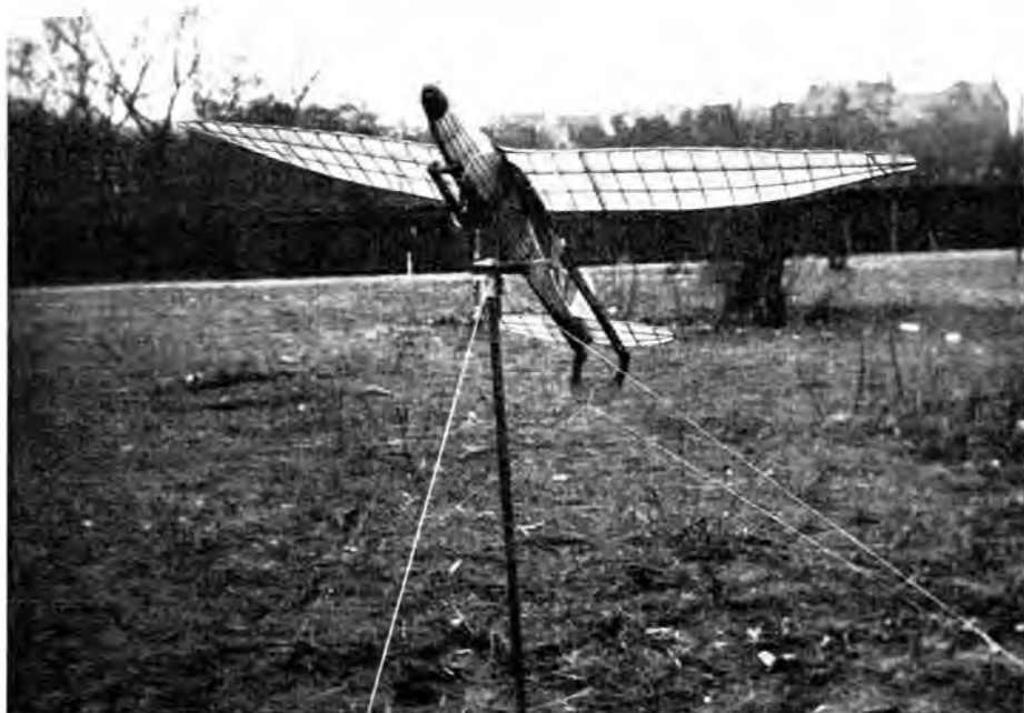
Der Flugmodellhalter mit eingesetztem Segelflugmodell in Startstellung. Die am Ende der Flugmodellführung sichtbare Spannungsschnur ist nur der Aufnahme wegen befestigt.
