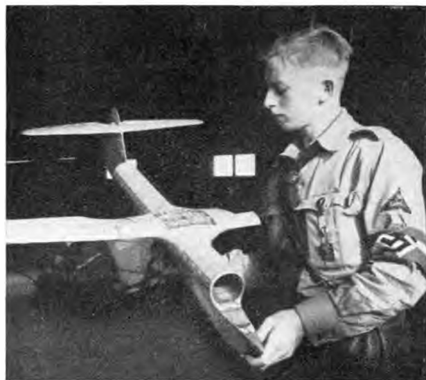
Abb. 8. Flugmodell von Alfred Kahle mit Kompaß-Düsen-Richtungssteuerung.
