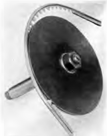
Abb. 7. Biegeschablone für Randbogen aus dem Profilband Nr. 7.
