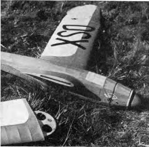
Abb. 12. Sich bewährende ausklübbare Flügelbefestigung am Flugmodell von Paul Adolph Richter.
