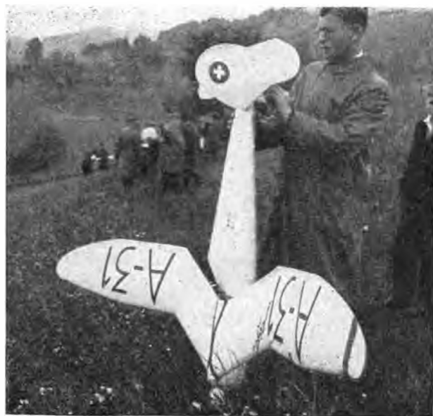
Abb. 4. Bei diesem Schweizer Segelflugmodell tritt die Dicke des nach der internationalen Rumpfformel gebauten Rumpfes besonders stark in Erscheinung.
