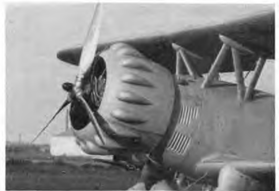
Abb. 39. NACA-Haube zur Verkleidung eines Sternmotors.
