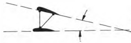
Abb. 36. Schränkung zwischen den beiden Tragflügeln eines Doppeldeckers.
