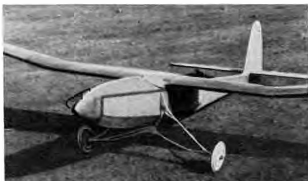
Abb. 1. Das Segelflugmodell mit Fahrgerüst und hochgelegtem Bugstarthaken.
