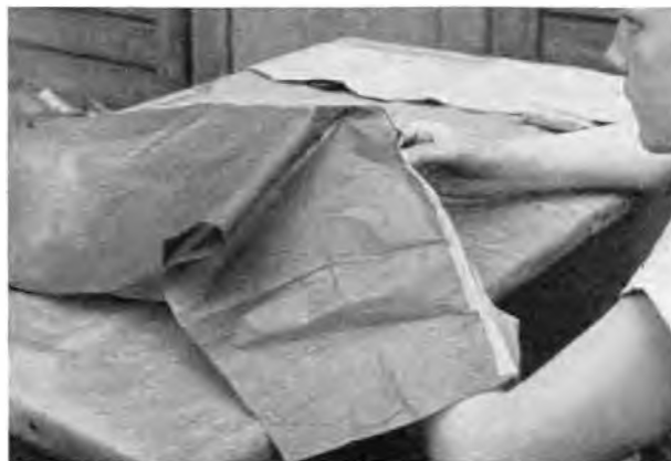
Abb. 6. Jede Klebenäht muß nach Fertigstellung geprüft werden. Sechs Klebenähte halten die Hülle zusammen.
