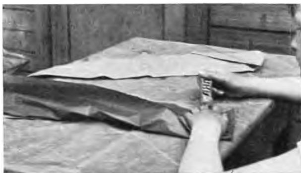
Abb. 5. Ebenso einfach ist das Umfalten u. Kleben der Längsnähte.
