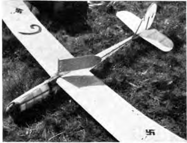
Abb. 10. Eine der verschiedenen Steuerungen des Seitentruders mittels Windfahne.
