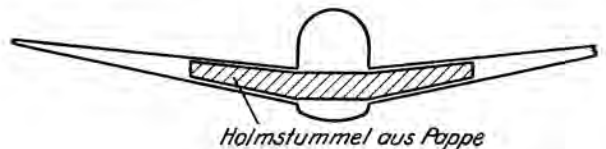
Abb. 8. Verstärkung der Flügel durch Holmstummel.
