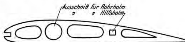
Abb. 2. Rippe des Tragflügels mit Rohrholm.
