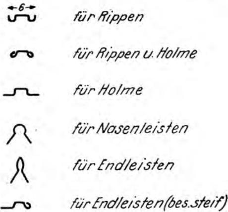
Abb. 18. Verschiedene Leichtmetallprofile aus einem Profil.
