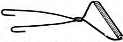
Abb. 7. Haltehaken für den Lagerstift bei Anfänger-Flugmodellen.
