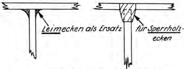
Abb. 5. Leimecken sind einfacher als Sperrholzecken.
