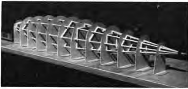
Abb. 4. Einsetzen der Spantstege.
