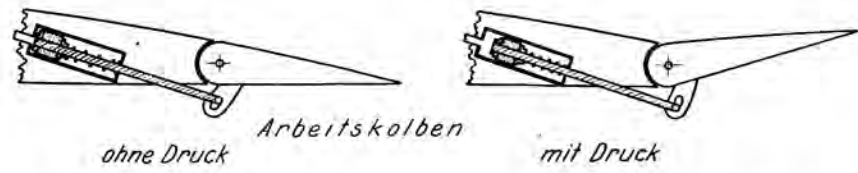
Aufbau und Wirkungsweise der Doppelkreisel-Kurssteuerung mit hydraulischer Kraftübertragung.
