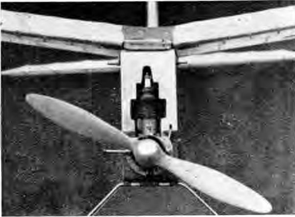
Abb. 15. Benzinmotor in einer Blechverkleidung des Rumpfkopfes
