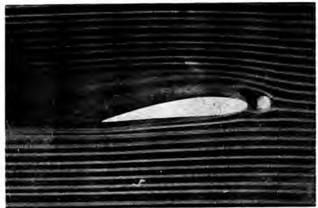
Abb. 7. Dicker Turbulenzdraht vor einem Flugmodell-Tragflügelprofil
