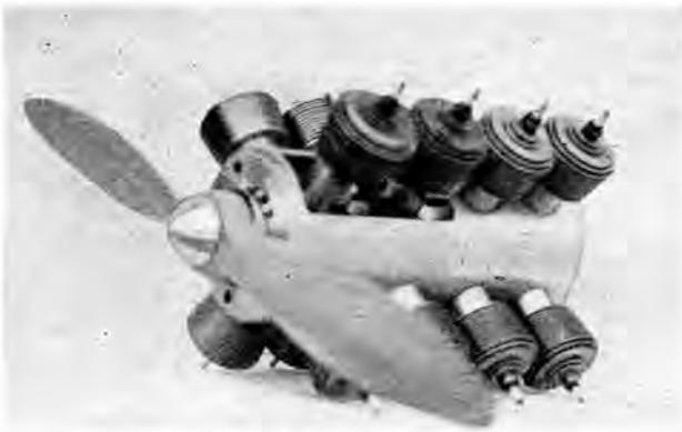
Abb. 10. Der 16-Zylinder-Motor Kratmo 30
