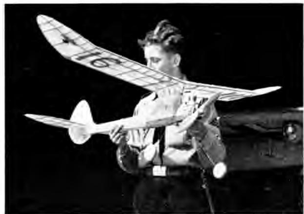
Abb. 13. Benzinmotor-Flugmodell mit Baldachin-Tragflügel
