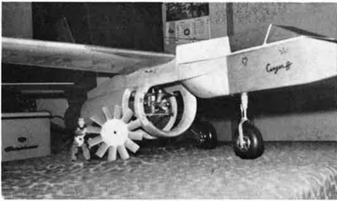
Vue partielle de l'OS 19, turbine démontée.
