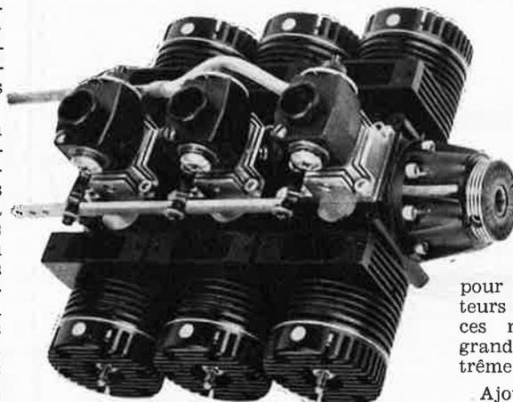
On notera que M. Ross travaille sur les mêmes cotes d'alésage et de course (alésage 20,3 mm, course 15,2 mm). Ces cotes donnent pour le 2 cylindres Flat-Twin exactement 9 cc, 832 (catégorie 10 cc), pour le 4 cylindres 19 cc, 66 (1,2 cubic inch, catégorie 20 cc) et pour le 6 cylindres 29 cc 49 (1,8 cubic inch), catégorie 30 cc. Nous indiquons sur le schéma les dimensions principales du 0,60 Twin de 10 cc.
