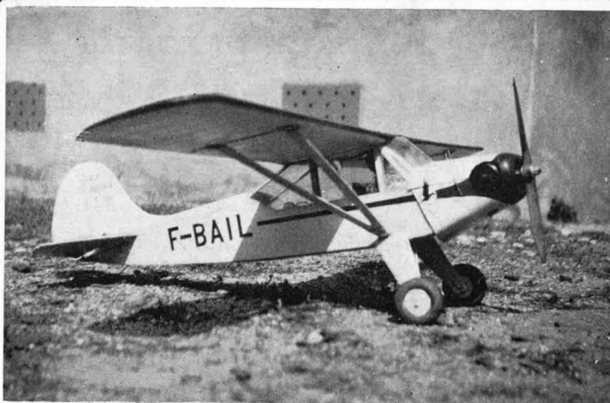
M. A. Lenoir, du Club de Villefranche (Rhône) est un fervent des maquettes de vol circulaire qu'il réussit fort bien, comme ce Boisavia « Mercury » de 1 m 49 d'envergure et d'un poids de 1 kg 700 tiré par un Micron 10 cc à glow.
