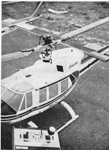
Fuselage fiberglass, grande bulle avant en plexi, mécanique de haute précision avec le pas général lié aux gaz, c'était une réalisation de toute beauté, tant par l'aspect général que par la finition des pièces mécaniques. Construction amateur, certes, mais pas du tout bricolage !... ,
