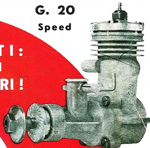
Albero montato su due cuscinetti a sfere. Fusione interamente sotto pressione. Due fasce elastiche. Scarico e travaso ampliati. Pistone in lega alluminio speciale. Peso gr 108. Potenza CV 0,29 a 15500 giri al minuto. Cil. cc. 2,48
