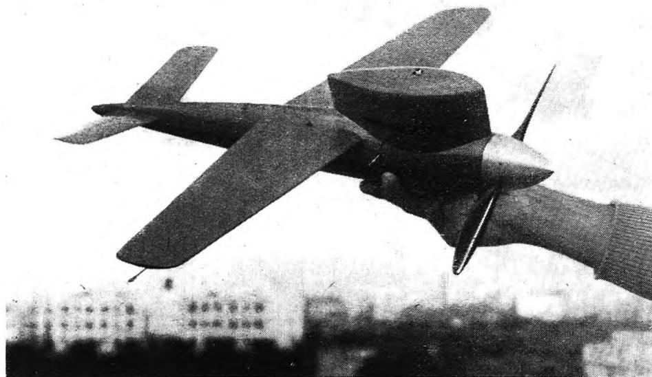
Questo bel modello controllato in volo circolare da velocità è stato realizzato dal barese Vincenzo Scardicchio; monta un motore Dooling 61, pesa 820 grammi ed ha raggiunto una velocità di 197 km/orari. Osservare l'eccellente finitura e la pulitezza aerodinamica.
