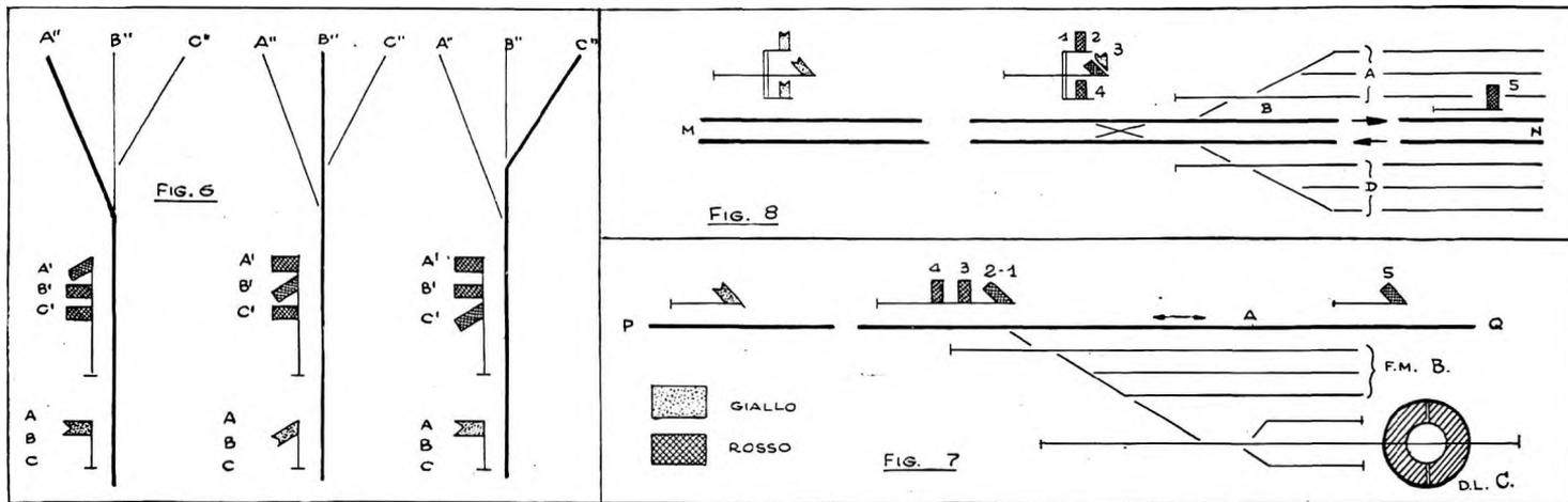
FIG. 6 - Segnale di avviso a quelli di 1. cat. A' B' C';
