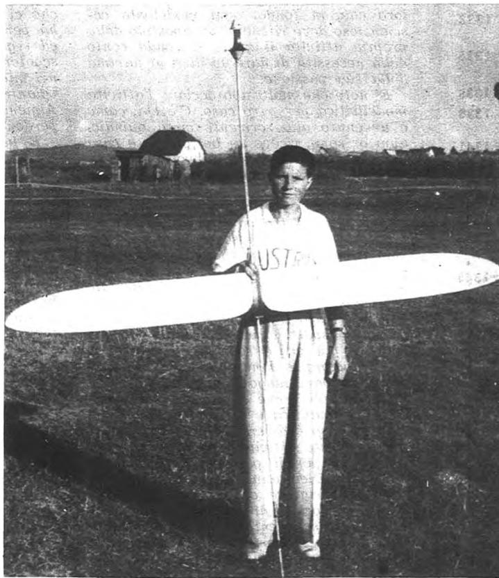
**Un caratteristico modello austriaco dalla lunghissima fusoliera a bastone di legno. Si noti che la sezione maestra è raggiunta con il rigonfiamento posto sotto il piano di coda orizzontale. Costruttore Stelmüller. 5° classificato**
