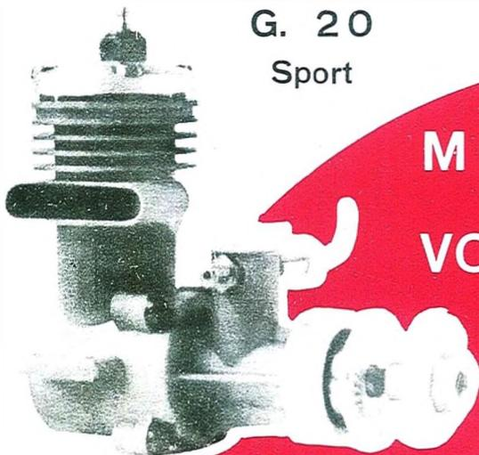
L'albero è montato su un cuscinetto a sfere. Fusione interamente sotto pressione in lega speciale. Pistone in lega d'alluminio munito di due fasce elastiche. Peso gr. 100. Potenza CV. 0,25 a 15.000 giri al minuto. Cil. cc. 2,48
