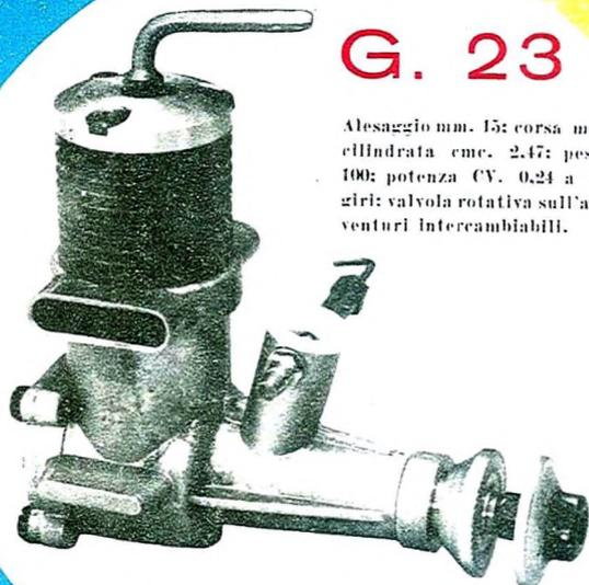
Alesaggio mm. 15; corsa mm. 14; cilindrata cmc. 2,47; peso gr. 100; potenza CV. 0,24 a 13.500 giri; valvola rotativa sull'albero; venturi intercambiabili.
