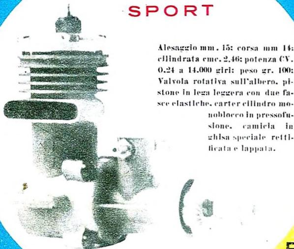
Alesaggio mm. 15; corsa mm. 14; cilindrata cmc. 2,46; potenza CV. 0,24 a 14.000 giri; peso gr. 100; Valvola rotativa sull'albero; pistone in lega leggera con due fasce elastiche; carter cilindro monoblocco in pressofusione; camiera in ghisa speciale rettificata e lappata.
