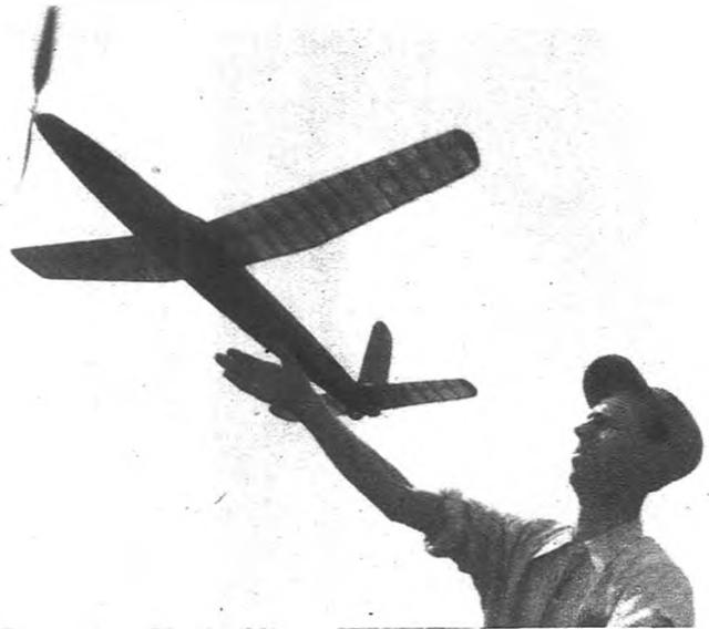
**Timone di profondità:** In un sol pezzo. Costruzione analoga all'ala, viene appoggiato sopra l'estremità posteriore della fusoliera e fissato opportunamente con elastici. Peso 8 grammi.
