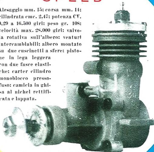
Alesaggio mm. 15; corsa mm. 14; cilindrata cmc. 2,47; potenza CV. 0,29 a 16.500 giri; peso gr. 108; velocità max. 28.000 giri; valvola rotativa sull'albero; venturi intercambiabili; albero montato su due cuscinetti a sfere; pistone in lega leggera con due fasce elastiche; carter cilindro monoblocco pressofuso; camicia in ghisa al nichel rettificata e lappata.
