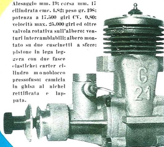
Alesaggio mm. 19; corsa mm. 17; cilindrata cmc. 4,82; peso gr. 198; potenza a 17.500 giri CV. 0,80; velocità max. 25.000 giri ed oltre; valvola rotativa sull'albero; venturi intercambiabili; albero montato su due cuscinetti a sfere; pistone in lega leggera con due fasce elastiche; carter cilindro monoblocco pressofuso; camicia in ghisa al nichel rettificata e lappata.
