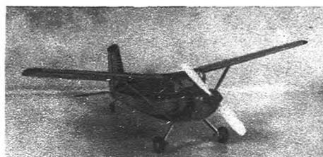
Apertura alare cm. 46 - Lunghezza cm. 32 - Fusoliera interamente in balsa del tipo scatolato. Impennaggio in balsa. Ala a centine di nuovo sistema costruttivo, di massima semplicità e resistenza. La scatola comprende: Tutti i pezzi tagliati e prefabbricati. Fiancate laterali fusoliera tagliate, centine alari ed impennaggi tagliati e pronti al montaggio, routine gommate, organi del telecomando, carrello prefabbricato, carta colorata, collante, parti in metallo, ecc.
