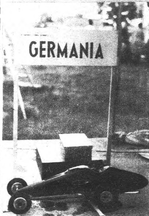
In alto: il gruppo dei concorrenti. Sopra a sinistra: lo svedese Zetterstrom ha dominato la classe 10 cc. con questa Fox munita di Dooling 61 a volano magnete. A destra: la macchina del tedesco Lallinger, seconda classificata nella classe 5 cc.; motore Dooling 29 e carrozzeria in fiberglass
