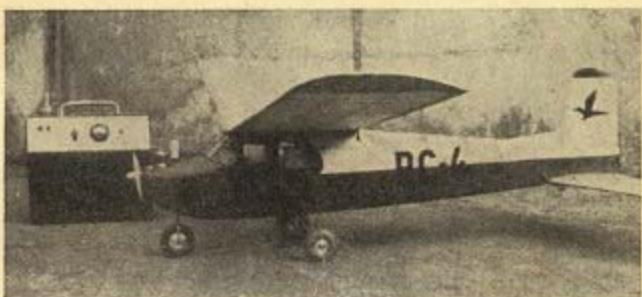
Rychlostní „desithu“ J. Gürtlera z Prahy na motor Dooling 61. Rozpětí 460; délka 450 mm; plocha 5 dm<sup>2</sup>; váha 950 g; rychlosť 222 km/h.
