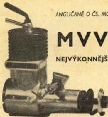
Takto je nadepsán test motoru MVVS - 2,5 D, uveřejněný v listopadovém čísle anglického časopisu Model Aircraft. Testován byl tedy typ, který se v zásadě liší od typu MVVS - 2,5/1958 (jeho popis jsem uveřejnil v LM 4/1958) pouze použitím kluzného ložiska místo ložiska kulíčkového. Proto neuvádějeme celý test časopisu Model Aircraft a omezíme se pouze na uvedení těch nejzajímavějších odstavců, které citujeme:
